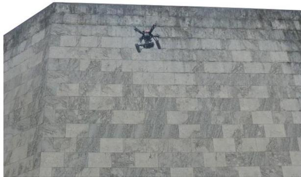
Die digitalen Fotos für die Auswertetechnik SfM wurden von einem Quadrocopter aus gemacht. Die hochauflösenden Fotos können auch zur visuellen Begutachtung des Zustands der Fassadenplatten dienen.
