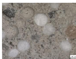
Betrachtung von Polystyrolkugeln innerhalb eines modernen Leichtputzes
