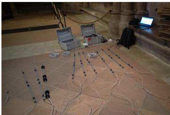
Messlanzen vor dem Einbau ins Mauerwerk
