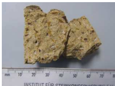
Schlitz, Ringmauer 20, Proben des Steinputzes von 1927
